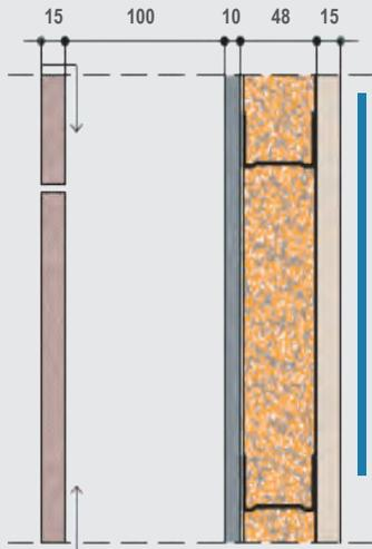
Revestimiento exterior continuo fijado mecánicamente 15mm.
