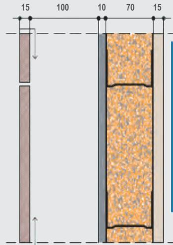
Revestimiento exterior continuo fijado mecánicamente 15mm.
