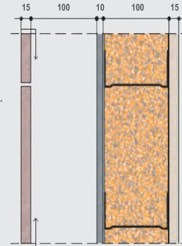
Revestimiento exterior continuo fijado mecánicamente 15mm.
